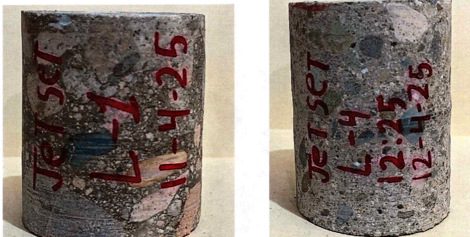
IMAGEN 32: TESTIGO LOSA L-1 Y L-4
