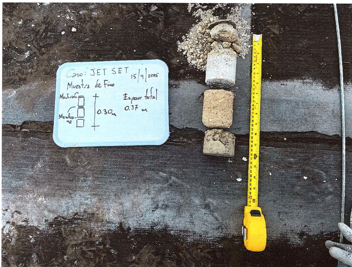
IMAGEN 12: FOTO DE LA MUESTRA DE LA EXTRACCIÓN DEL NÚCLEO DE FINO.
