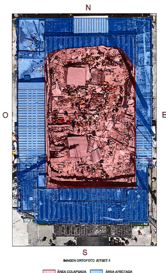
IMAGEN 6: ESQUEMA IDENTIFICACIÓN DE ÁREA COLAPSADA
