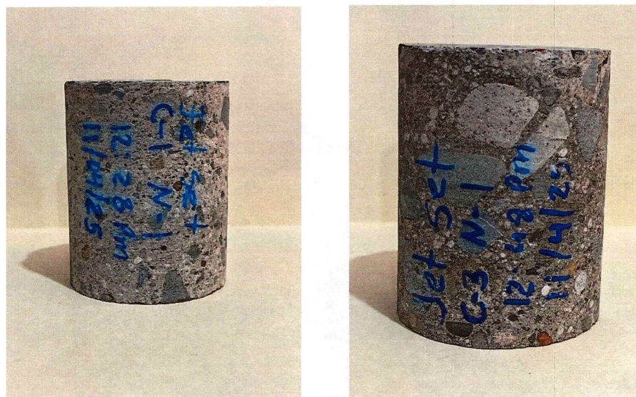
IMAGEN 29: TESTIGO COLUMNA C-1 Y C-3
